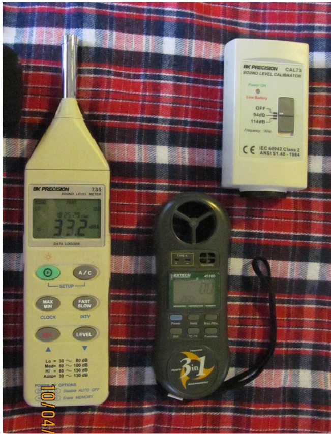
Figura. 2 Equipo de medición: Sonómetro, calibrador, termómetro y anemómetro.
