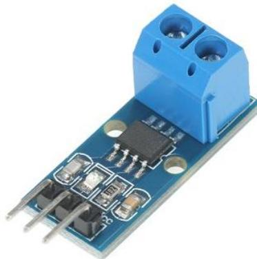
Figura 6.0: Sensor de corriente ACS712.
